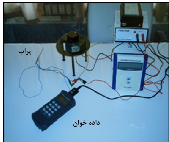
شکل ۵- پراب اندازه‌گیری هدایت حرارتی پوست و پی
