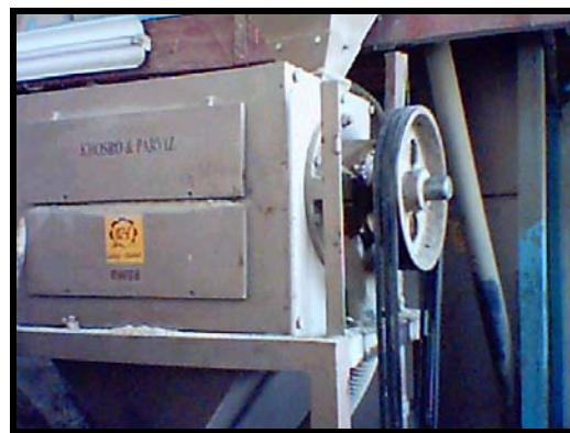
شکل ۱ - دستگاه سفیدکن سایشی افقی
