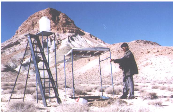
شکل ۲- نمایی از باران‌ساز مورد استفاده در صحرا
