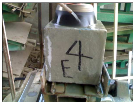
شکل ۱- نمونه بتن در حال سایش با استفاده از دیسک چرخان
