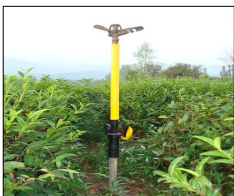
شکل ۵- شیر خودکار، پایه‌ی آبیاش و آبیاش در سامانه آبیاری بارانی ثابت-آبیاش متحرک
