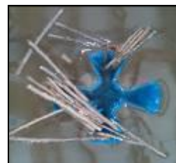
ب- سرریز چهار سیکل Q=6/04 لیتر بر ثانیه و میزان انسداد \pi = 0/18
