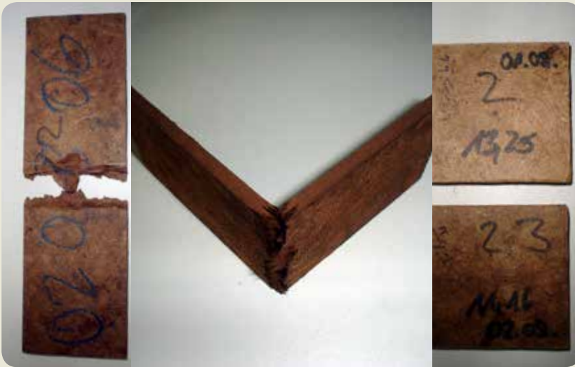
شکل ۳- مقایسه محصول چوبی به دست آمده از آنزیم لاکاز و بافر شیمیایی
