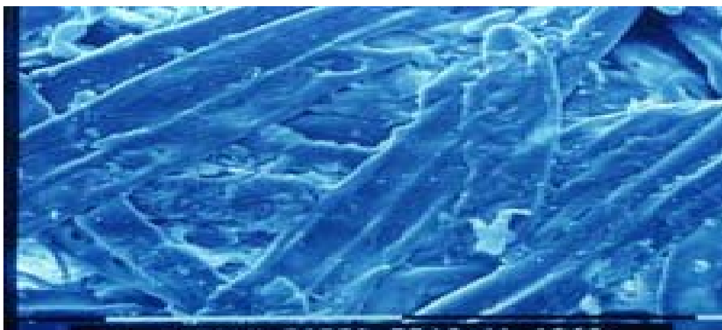
شکل ۷- تصویر میکروسکوپ الکترونی (SEM) از فایبر بردهای تولید شده از چوب کاج با لاکاز قارچ رنگین کمان ( Trametes Versicolor )
