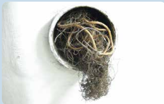
شکل ۳- دریچه‌های نصب شده روی بدنه لایسیمترها برای مطالعه خاک و ریشه
