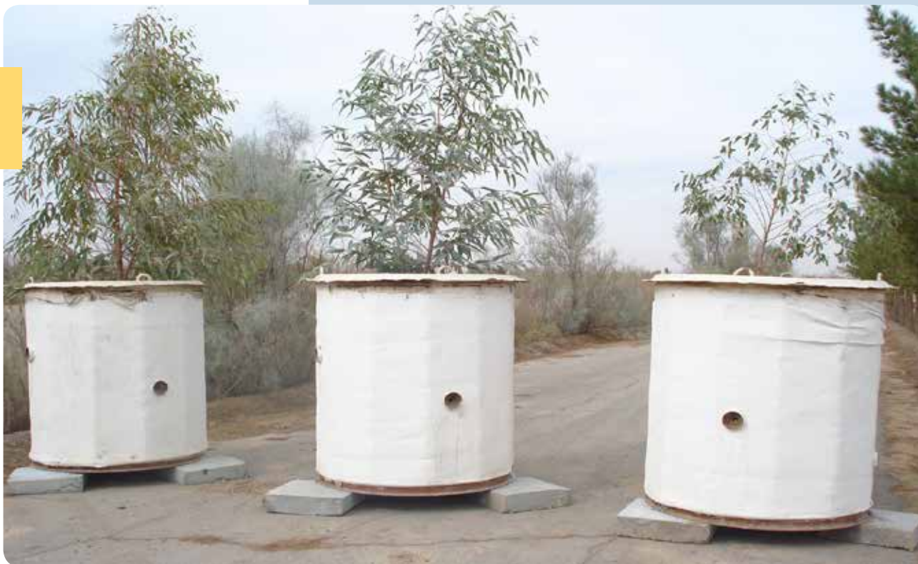
شکل ۲- لایسیمترهای خارج شده از سایت تحقیقاتی برای انجام مطالعات ریشه (پایان آزمایش)
