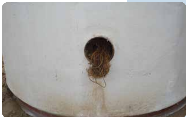
شکل ۳- دریچه‌های نصب شده روی بدنه لایسیمترها برای مطالعه خاک و ریشه
