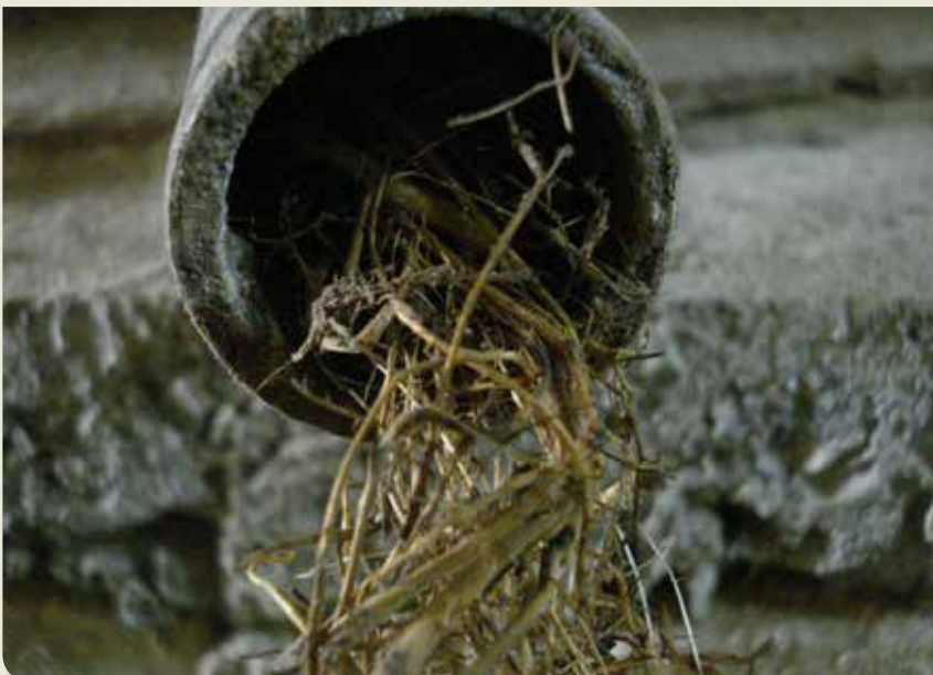
شکل ۵- نفوذ عمقی ریشه E. camaldulensis در تیمار آبیاری شاهد (۱۰۰ درصد ظرفیت زراعی) و خروج آن از زهکش لایسیمتر، برای برداشت آب بیشتر از مخزن جمع‌آوری زه‌آب
