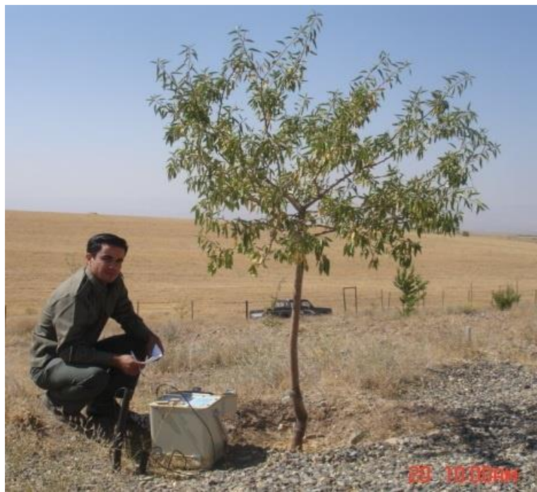
شکل ۲- نمائی از کشت نهال در سامانه آبیگر و دستگاه اندازه‌گیری رطوبت (TDR)
