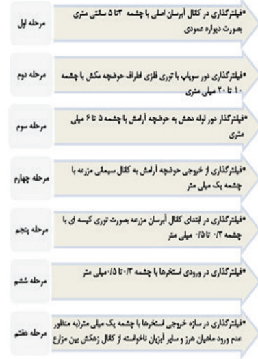
شکل ۲- مراحل فیلتراسیون آب در استخرهای پرورشی
