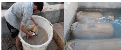
شکل ۸- بسته شدن چشمه‌های تورهای میکرونی و شستشوی آن‌ها
