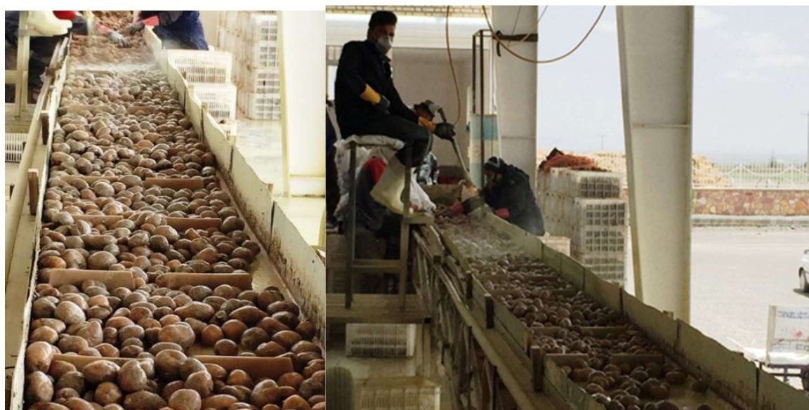
شکل ۵- ضدعفونی غده‌های سیب‌زمینی روی نوار نقاله در زمان سورت
