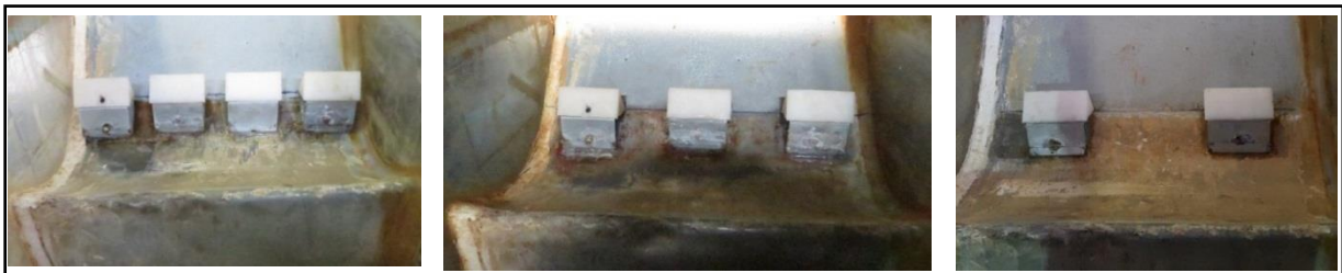
شکل ۳- تصویر قرارگیری دفلکتورها در پرتاب‌کننده جامی
