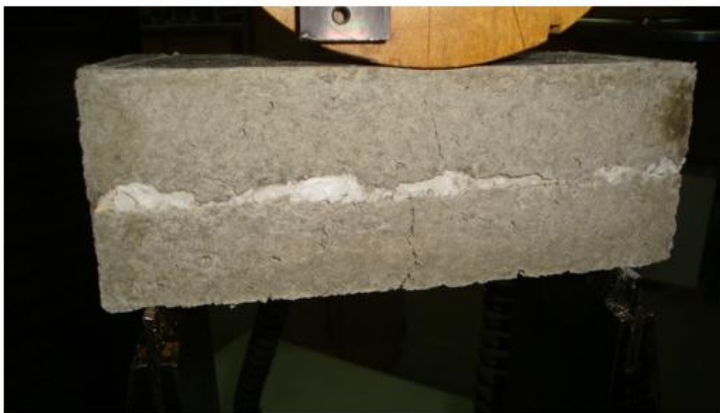
شکل ۵- نمونه‌های سیمان چوب یونولیت و آزمایش خمش نمونه
