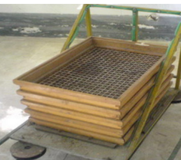
شکل ۲- دستگاه تفکیک علوفه جهت تعیین شاخص GML و انحراف معیار
