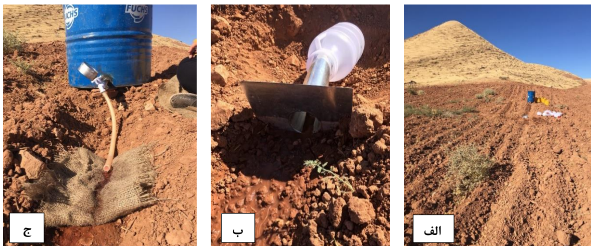
شکل ۲- نمای از گندم‌زار و شیارهای تحت کشت (الف)، استقرار لوله و مخزن رواناب و رسوب در انتهای نوار کشت (ب) و حوضچه با پوشش پارچه‌ای (گونی نخی) در ابتدای شیار (ج)
