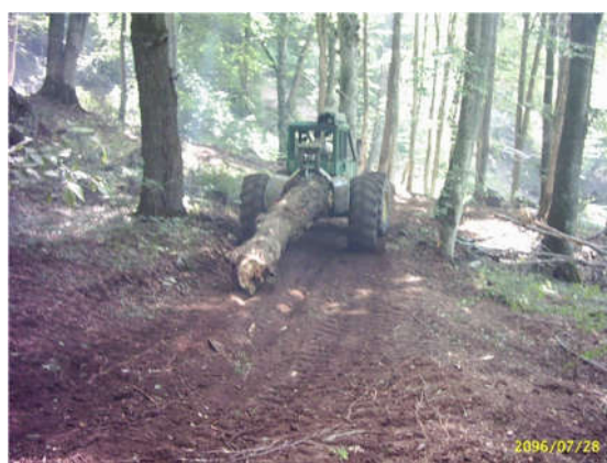
شکل ۵ و ۶- عملیات کشیدن تنه توسط اسکیدر و اثر تردد اسکیدر بر فشردگی خاک در طول مسیر چوبکشی
