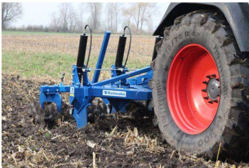
شکل ۲- زیرشکنی رایج (کل سطح خاک)
