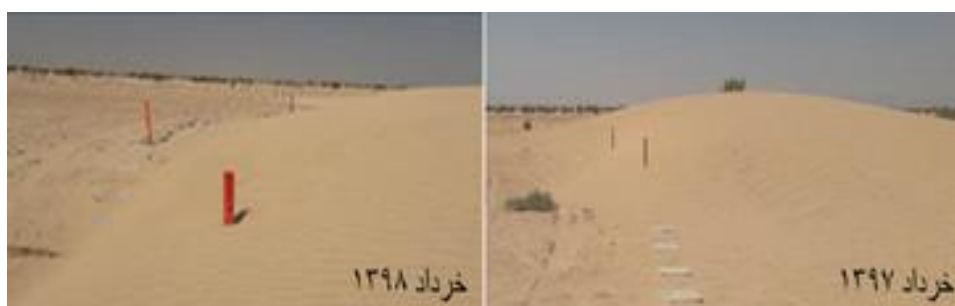
شکل ۸- جابجایی تپه شاهد نسبت به شاخص‌های نصب شده
