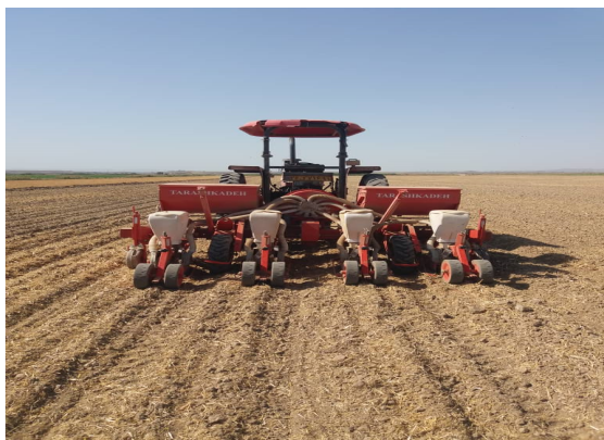
شکل ۲- بذرکار مورد استفاده در تیمار کاشت مرسوم با بذرکار دوقلو
