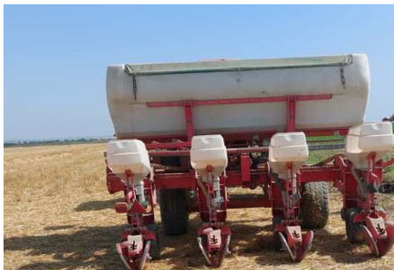
شکل ۱- بذرکار مورد استفاده در تیمار کاشت مستقیم سویا
