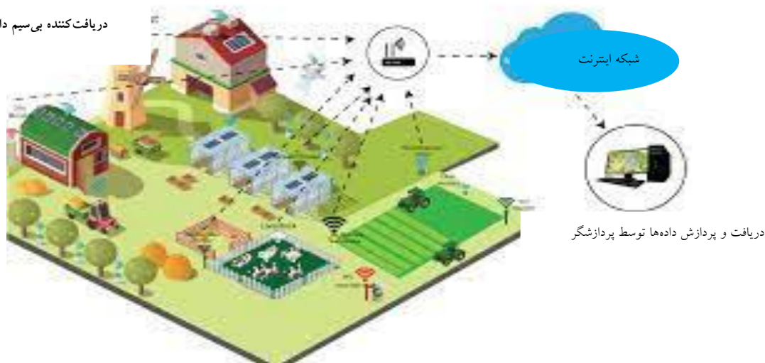
شکل ۱- شبکه‌ای از سامانه‌های دریافت، پردازش و مبادله اطلاعات اینترنت اشیاء در مدیریت هوشمند کشاورزی
