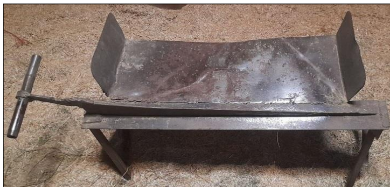
شکل ۳- داس مخصوص برای خرد کردن شاخ و برگ گیاه سیب زمینی
