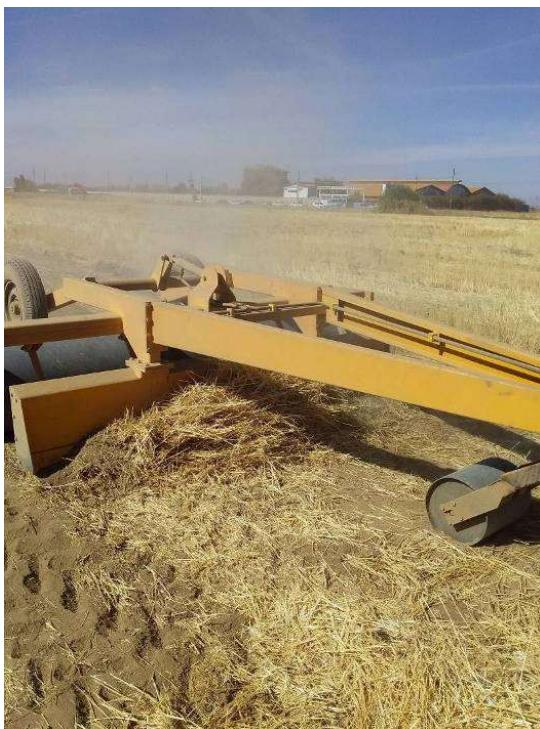
شکل ۳- جمع شدن کاه و کلش گندم در جلوی ماشین تسطیح کن غلتکدار
