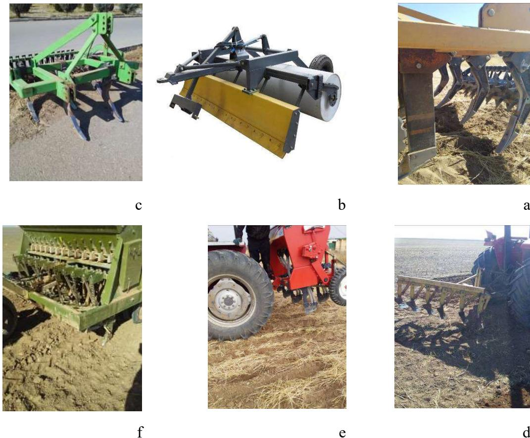
شکل ۱- ماشین‌های مورد استفاده (a- خاکورز مرکب مجهز به تیغه‌های زیرشکن، قلمی و غلتک ، b- سطحیگر کن غلتکدار، c- چیزل‌پکر، d- شش خیش و e- خطی‌کار کودکار کشت مستقیم و f- عمیق‌کار)
