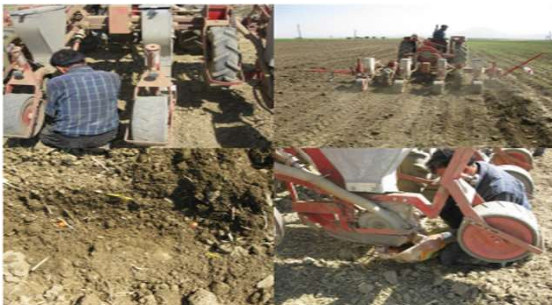
شکل ۱. تنظیم عمق و فاصله روی ردیف دستگاه ردیف‌کار پنوماتیک ذرت برای ارقام زودرس
