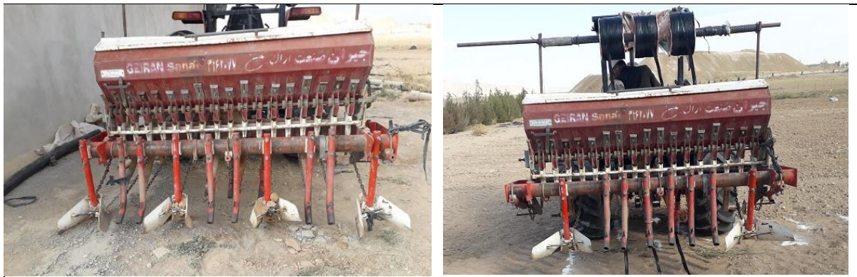
شکل ۲- اصلاح خطی کار برای دو حالت بستر با عرض ۳۰ سانتی‌متر (سمت چپ) و بستر با عرض ۸۰ سانتی‌متر (سمت راست) Fig. 2- Modification of the grain driller for two bed situations with a width of 30 cm (left side) and a bed with a width of 80 cm (right side)
