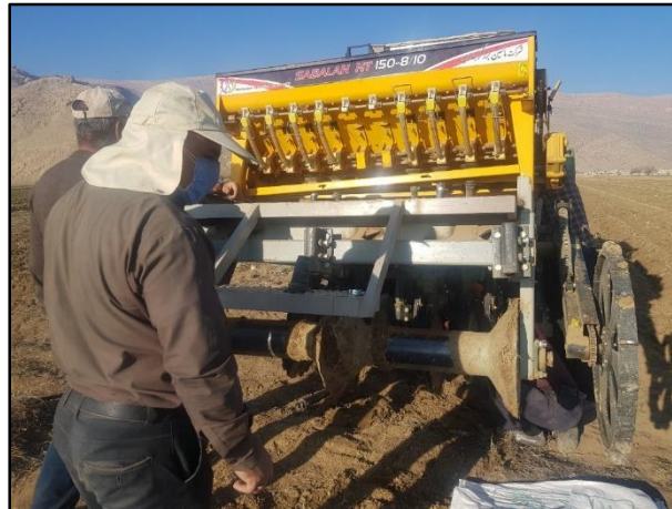
شکل ۲- کارنده کشت روی پشته بلند و عریض
