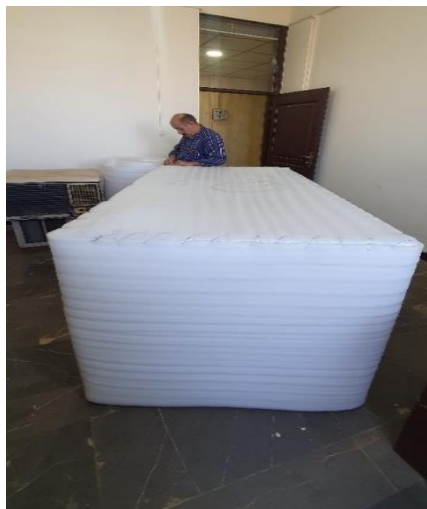
شکل ۲- اتصال فوم پلی اتیلن به چهارچوب اتاقک توسط سیم مفتولی
