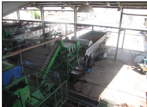
شکل ۲- دستگاه‌های پوست‌گیری پسته (راست) و بارگیری محصول فرعی پسته برای انتقال به خارج از محوطه پایانه (چپ)
