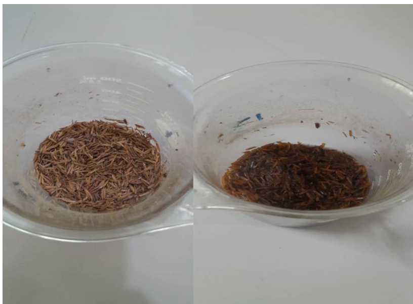
شکل ۲- پوسته شلتوک جوشانده و شسته شده (راست) و خشک شده (چپ) برای استخراج سیلیس
