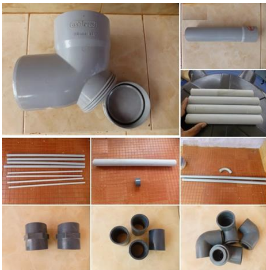
شکل ۲- قطعات پی وی سی برای تغذیه بیوگاز و خروجی دوغاب
