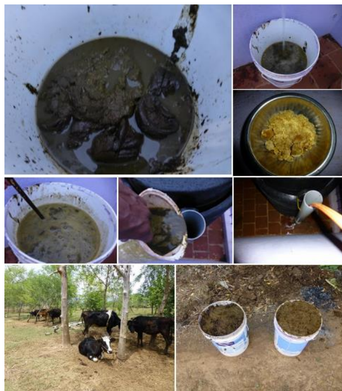
شکل ۷- تغذیه نیروگاه بیوگاز خانگی برای نخستین بار با سرگین گاو
